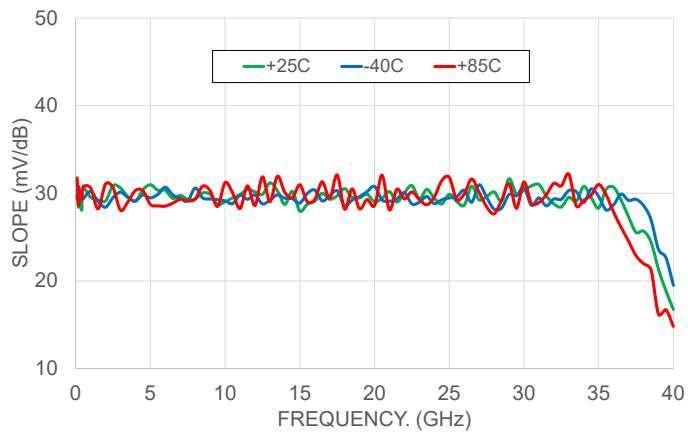
SLOPE Vs FREQUENCY OVER TEMPERATURE RANGE
