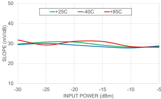
SLOPE Vs INPUT POWER OVER TEMPERATURE RANGE
