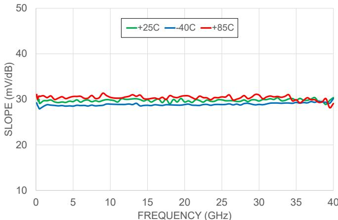
SLOPE Vs FREQUENCY OVER TEMPERATURE RANGE
