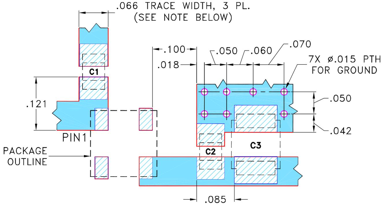
CAPACITORS C1,C2: 39000 pF, EIA CODE (MM): 2012
